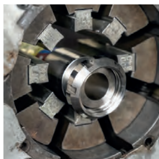
Sertissage de flexibles
