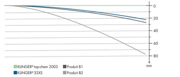
Test de rigidité réalisé sur une bande calibrée de longueur 200mm x largeur 40mm x ép.3mm B1 et B2 sont des produits PTFE en micro-cellulaire ou spongieux avec âme rigide classique (ou PTFE à bi-structure)
