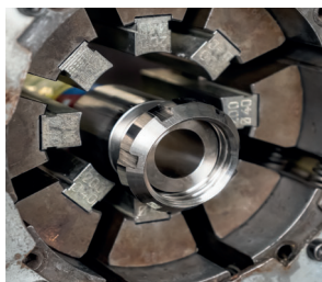
Sertissage de flexibles
